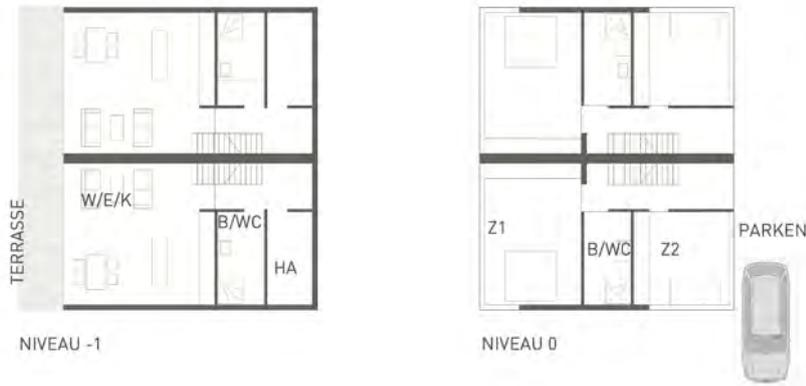
Schemagrundriss Hangdoppelhaus kompakter Typ (6 WE)
